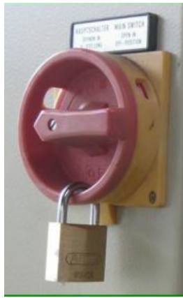
Foto: Schakelaar met hangslot bij storing aan machine binnen
