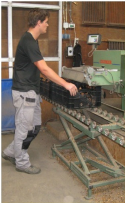
Afb.: Schaartafel (traploos in hoogte verstelbaar)
