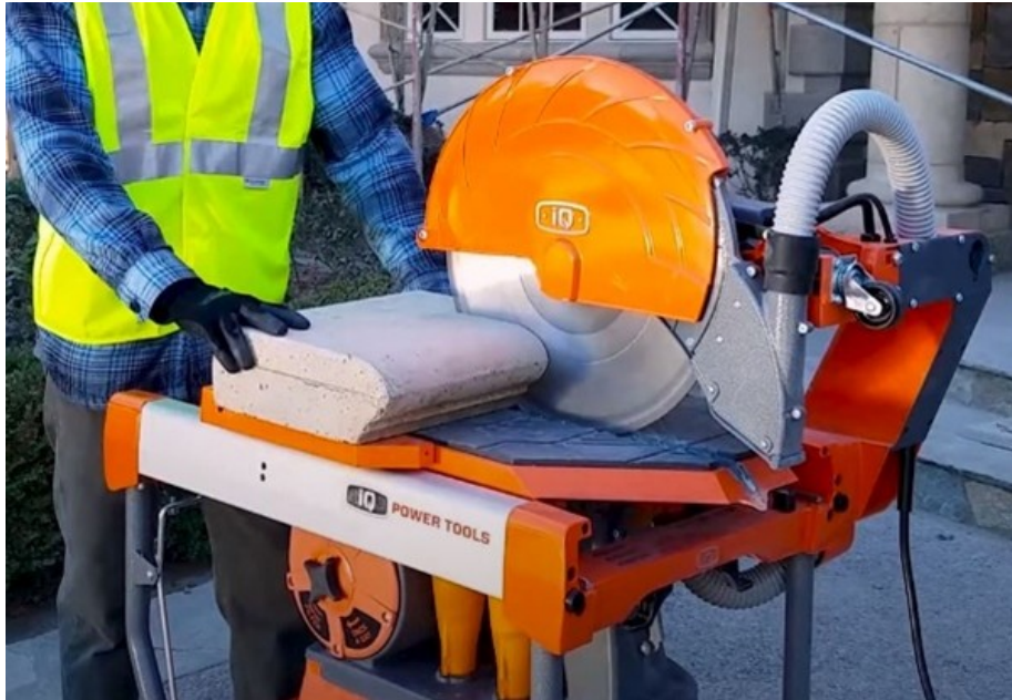
Afbeelding 2; zaagtafel met bronafzuiging
